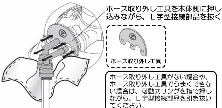
ホース取り外し工具を本体側に押し込みながら、L字型接続部品を抜く
