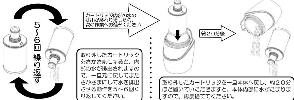
取り外したカートリッジをさかさまにすると、内部の水が排出されますので、一旦元に戻してまたさかさまにして水を排出させる動作を5~6回くり返してください。
