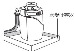
**4** ホース取り外し工具を使ってブラケットの可動式リングを押し込みながら、L字型接続部品を引き抜きます。引き抜く際は、必ずL字型接続部品周辺にタオルなどを当ててください。
